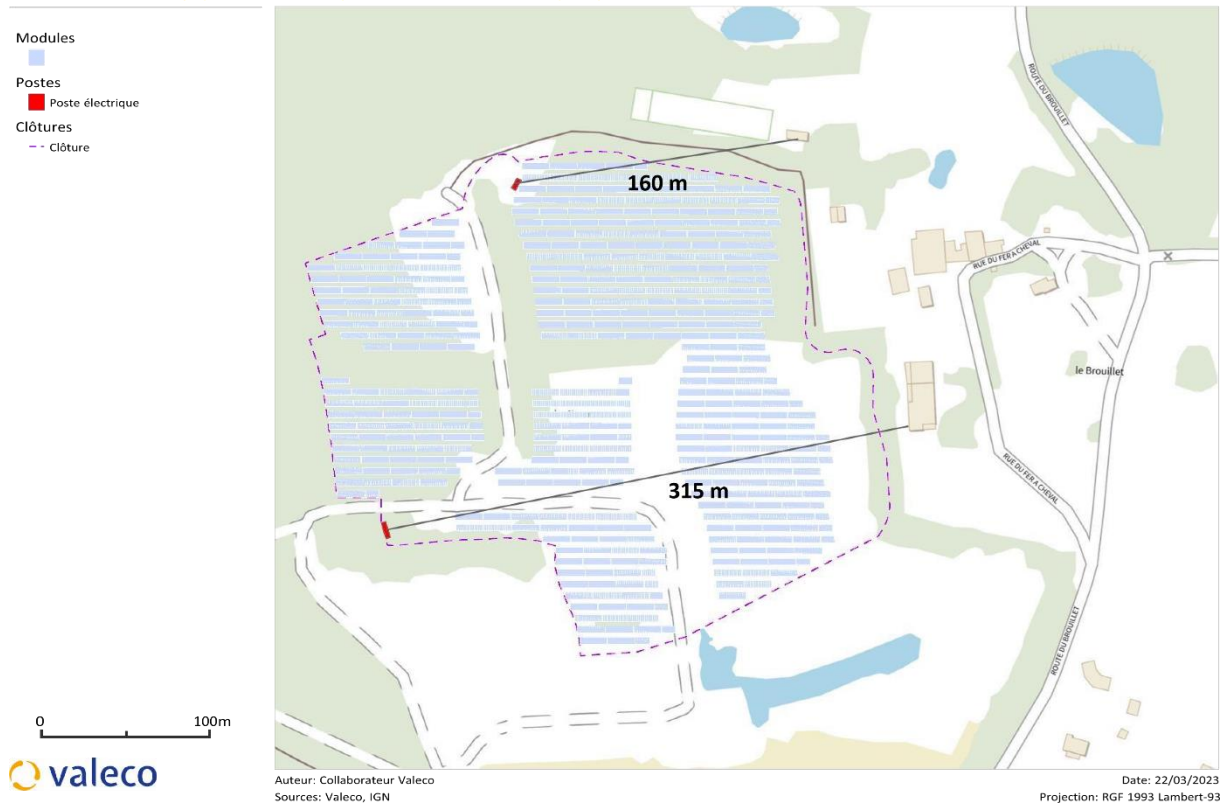
Carte 5 : distance entre les équipements électriques et les habitations les plus proches
